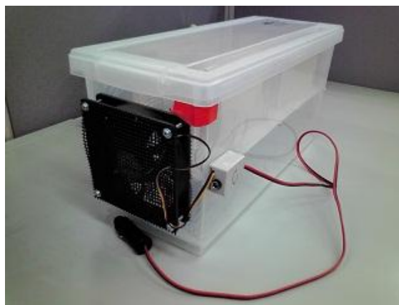
電動ファンを用いた予備乾燥装置 シガーライターソケットと家庭用電源両用
